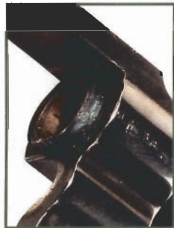
Heiße Gase lassen die „Magnumrille“ in der Rahmenbrücke entstehen.
