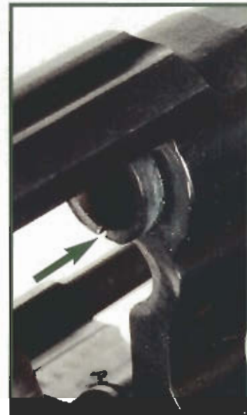
Falsches Timing: Der Übergangskonus ist gerissen.
