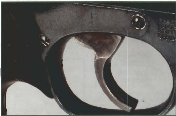
Vorsicht! Bei derartig geschundenen Schrauben war ein Bastler am Werk.
